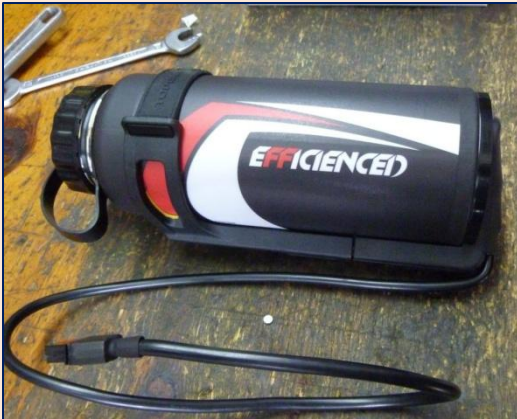
La batterie qui alimente le moteur
